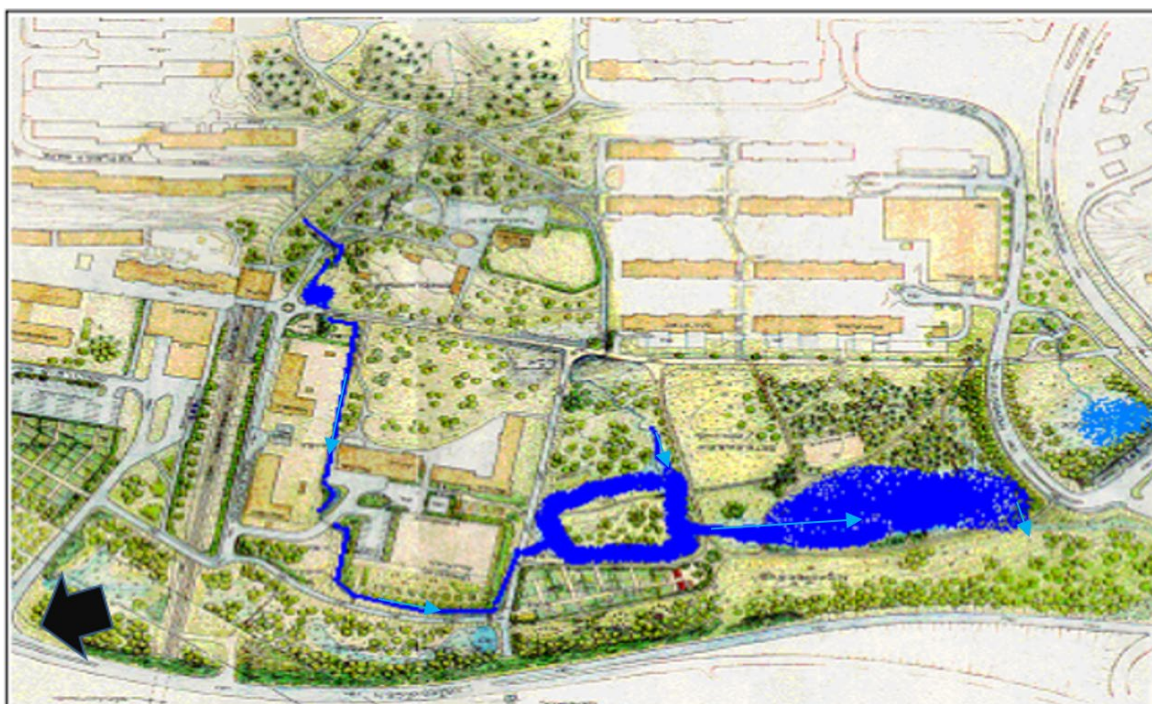
Figur 1. Utformning av Gärdsås dammsystem från senare delen av 1995. Bild från Louhi 2005. Pilar har lagts in i efterhand för att illustrera vattnets flödesriktningar i våtmarken.
